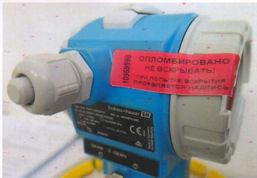
Рисунок 8 - Схема пломбирования корпуса преобразователя
